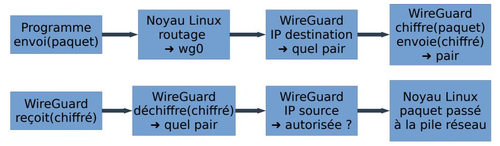
Si un paquet provient de l'interface wg0 avec une adresse correspondant à la clé, il est authentifié et accepté.
